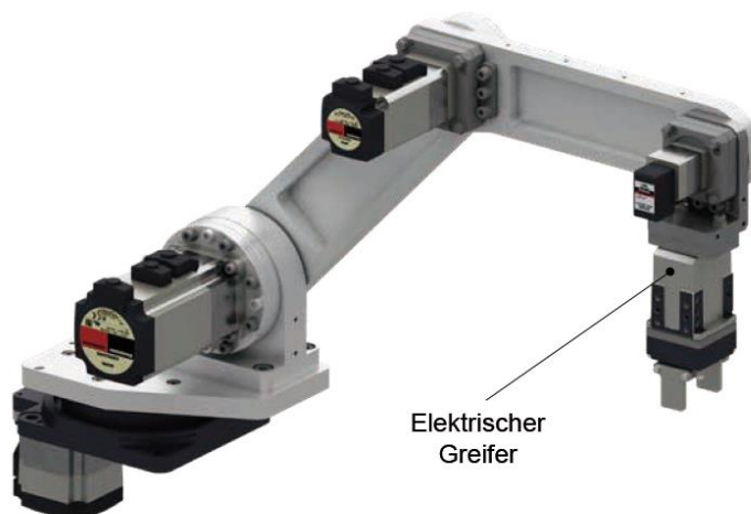
Abb. 1: Armroboter mit elektrischem Greifer als Endeffektor.
