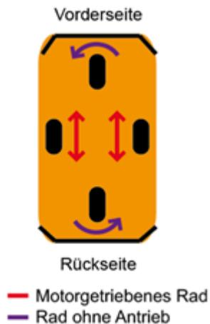
Abb. 4: Differentialantrieb
