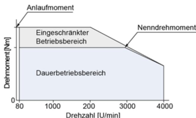
Abb. 7: Drehmomentkennlinie eines bürstenlosen Motors
