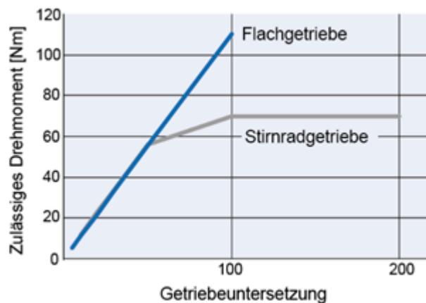
Abb. 11: Hohes zulässiges Drehmoment des Flachgetriebes
