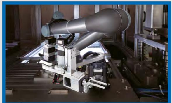
Individuell angefertigter SCARA-Roboter, der den begrenzten Raum unter dem Arm des Industrieroboters nutzt
